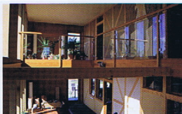
工場生産の木質パネルや土ブロックを組み立ててポリウレタンのある建物をつくる例。性能はパッシブハウス基準を満たす。
